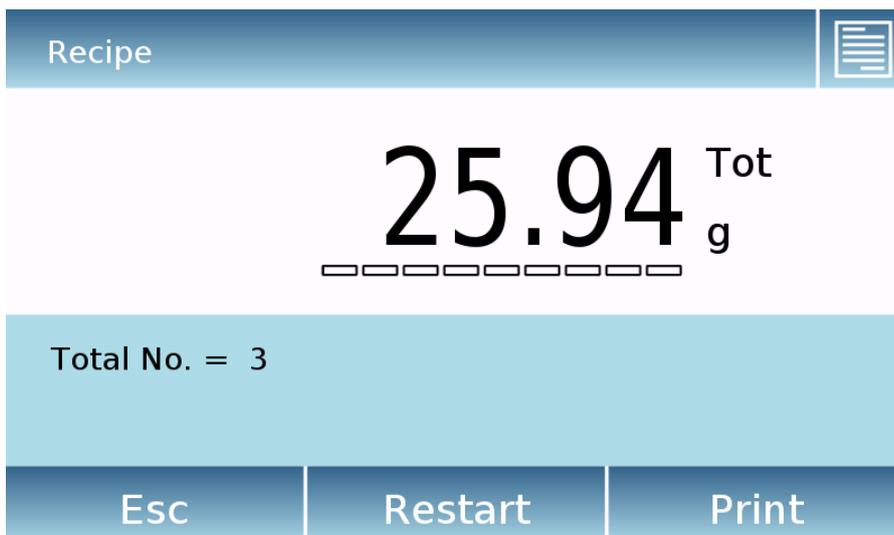
Коснитесь клавиши «Esc», чтобы выйти из функции, клавиши «Restart», чтобы выполнить новое измерение, и клавиши «Print», чтобы распечатать результат измерения.
