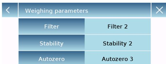
На экране "**Weighing parameters**" установите нужные параметры, касаясь значений в правой колонке.
