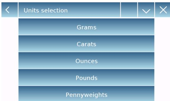
На экране "**Units Selection**" отображаются все доступные единицы измерения веса. Коснитесь нужной единицы, чтобы выбрать ее.
