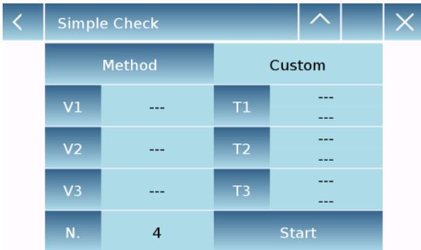
Если выбран пользовательский метод, можно определить количество взвешиваний («N»), значение проверяемых объемов до максимум трех («V») и относительные значения систематической и случайной ошибки.
