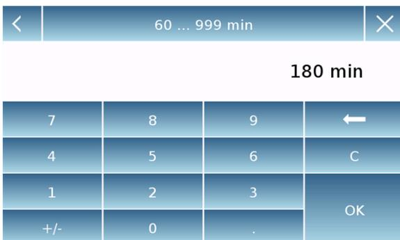
Чтобы изменить диапазон автокалибровки, коснитесь кнопки «Interval time» и установите желаемый диапазон от 60 до 999 минут.
