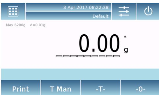
Если вес тары вводился вручную, для его удаления нажмите “T-Man” и затем “C”.
